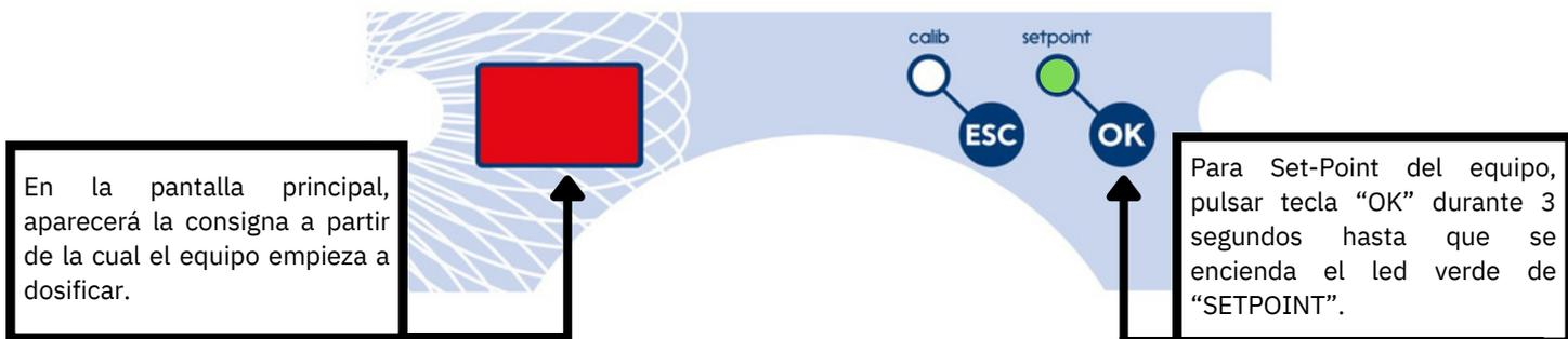
2. Para modificar el valor del Set-Point pulsar brevemente la tecla “OK” o “ESC” y se incrementarán los dígitos de la derecha e izquierda respectivamente.
